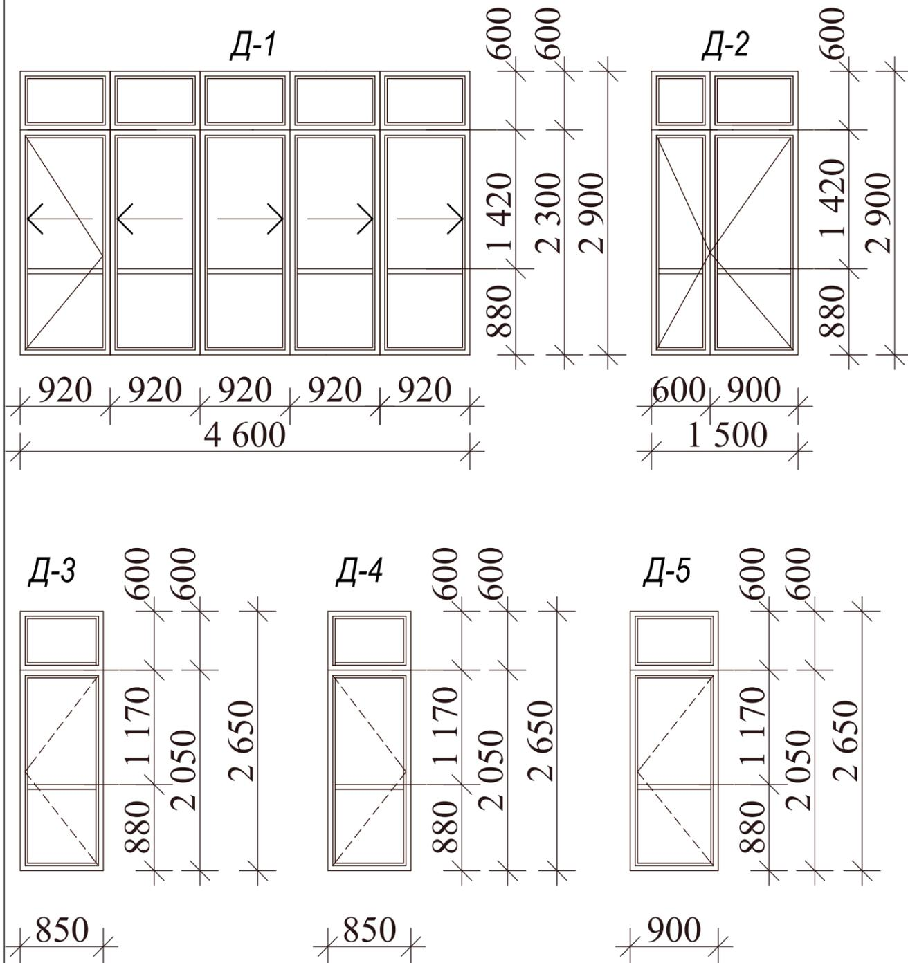
Спецификация элементов заполнения проемов
